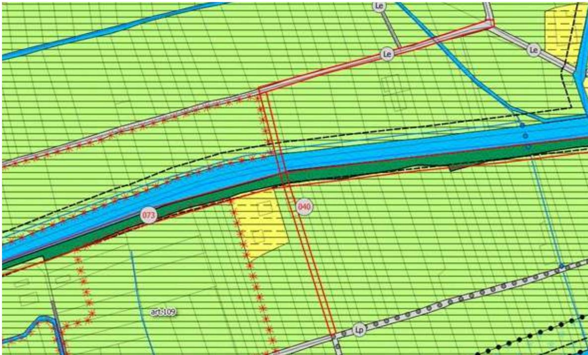
La previsione “strada di progetto” implica la realizzazione di una nuova strada di collegamento in un’area vincolata dal punto di vista idrografico. Nel caso specifico si dovrebbe prevedere la realizzazione di un attraversamento sul fiume Brenta e la demolizione di un edificio abitato. Non si intende, pertanto, reiterare il vincolo.
